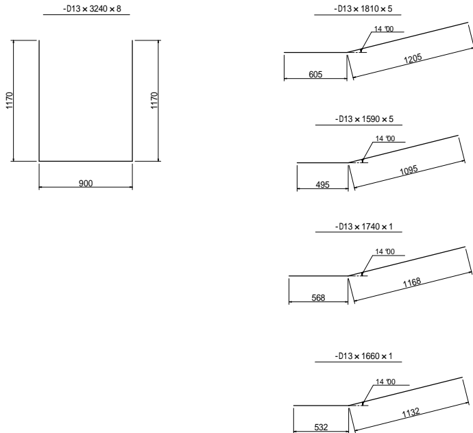
水路鉄筋加工図
